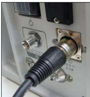
Entrada para a alimentação do Ventilador Microtak Total é feita através da Fonte de Alimentação AC/DC – 202012276 - Modelo: 15V-2,5 A / Entrada:127-220V – 0,7A / 50 – 60 Hz / 15V 2,5A (37,5W).
