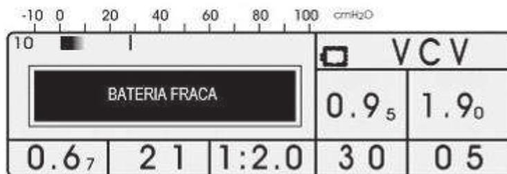
Quando a perda da alimentação elétrica for 30S ou menos, as CONFIGURAÇÕES DE ALARME anteriores à perda, devem ser restauradas automaticamente.
