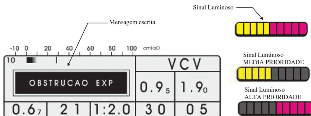
Figura 7.8: Tela principal com a ocorrência do alarme “OBSTRUÇÃO EXP” em destaque no display.
